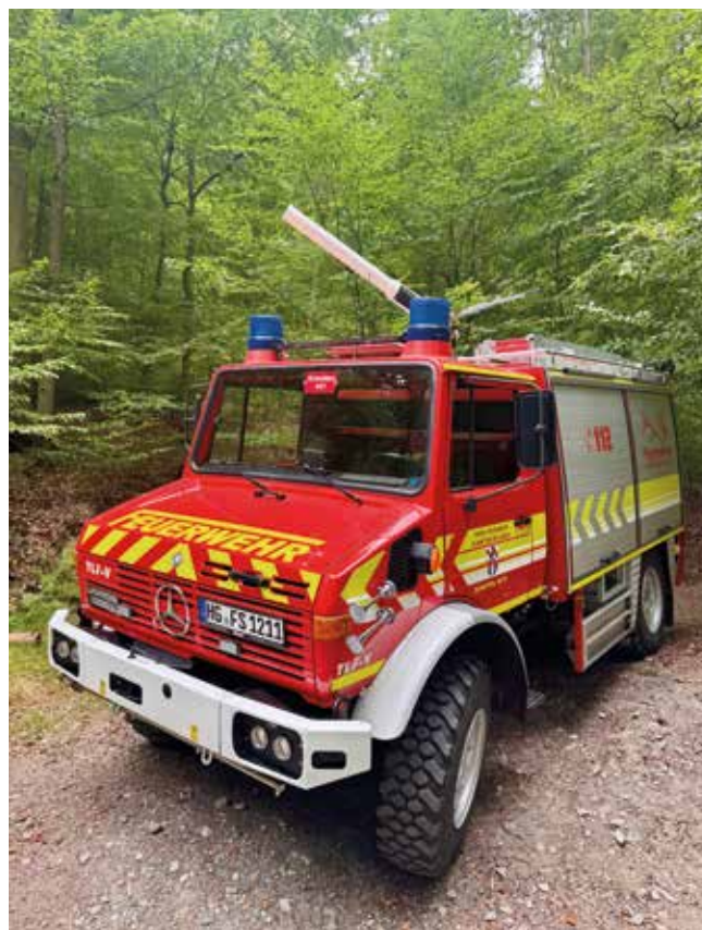
Das neue Tanklöschfahrzeug TLF 2000V, ein Unimog, ist stationiert bei der Feuerwehr Mitte in Arnoldschaint und für die Bekämpfung von Waldbränden ideal geeignet | Foto: gs
