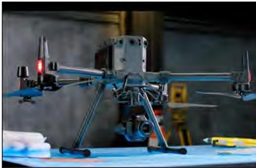
Abbildung 3: Vermessungsdrohne, Modell: DJI M300 RTK
